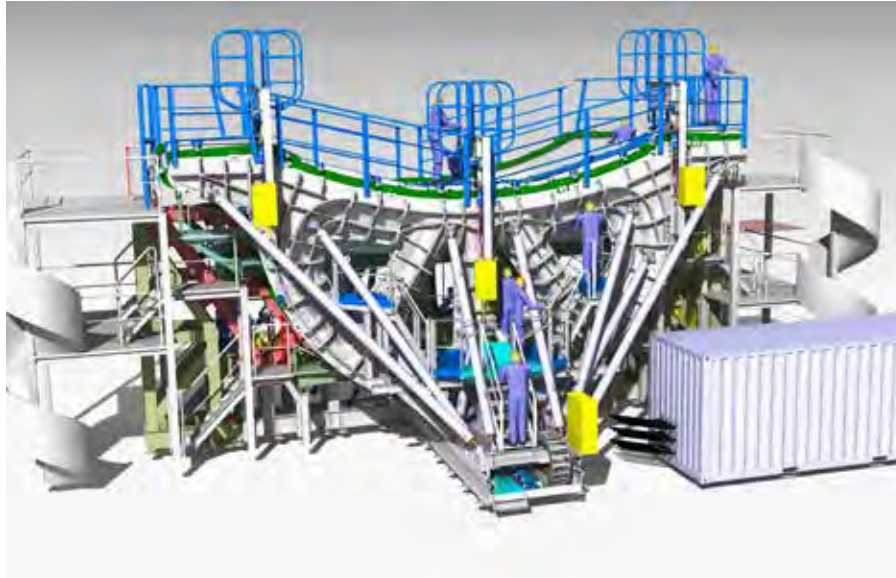
Entwicklung einer Betongussmaschine für die Tragstrukturen von CSP-Solarsystemen
