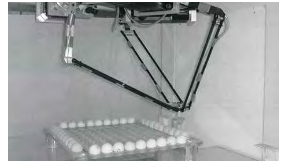
Mitentwicklung eines Parallelroboters: schnell und präzise
