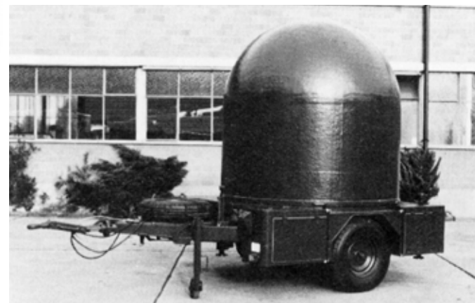
Vermessungsradar zur Sondierung der Atmosphäre
