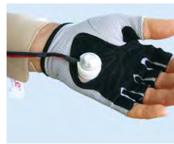
Entwicklung eines vibro-taktilen Stimulators zur Anwendung der Coordinated Reset®-Therapie an Schmerzpatienten
