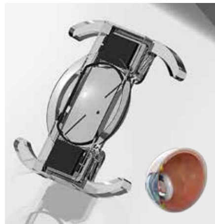
Elenza: Entwicklung einer elektroaktiven Intraokularlinse
