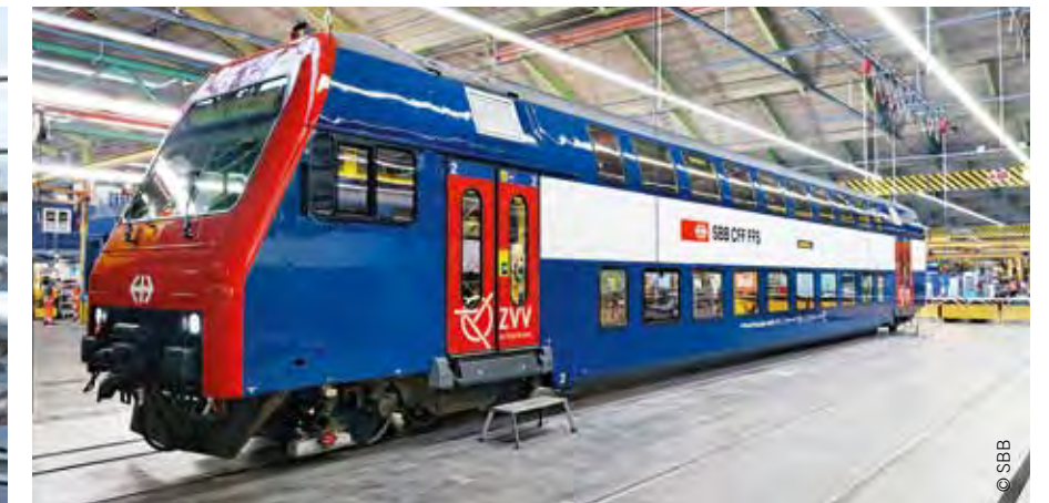
Der erste umgebaute Steuerwagen Bt DPZ eines Doppelstock-Pendelzugs der S-Bahn Zürich mit klimatisierten Fahrgasträumen
