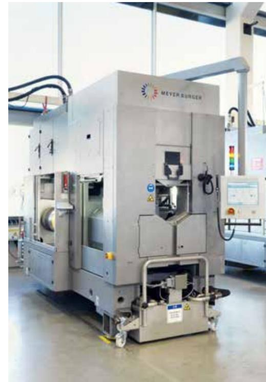
Diamantdrahtsäge für das Schneiden von monokristallinen Wafern
