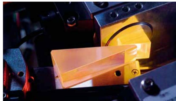
Optische Elemente für FT-NIR-Spektrometer (Fourier Transform Near Infrared)
