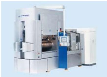
**Produktionsmaschine für die Solarindustrie für das Schneiden von Siliziumblöcken**
