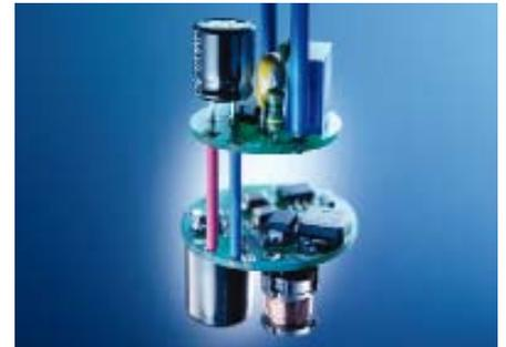
Elektronisches Vorschaltgerät für Energiesparlampen
