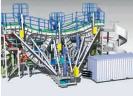
Gussmaschine für die Herstellung von Beton-Elementen für die tragenden Strukturen von thermischen Solarkraftwerken
