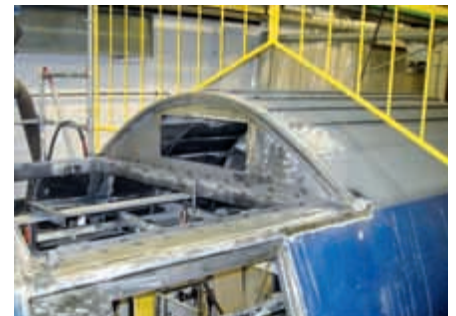
Dachausschnitt für die Nachrüstung der Klimaanlage am Steuerwagen Bt DPZ eines Doppelstock-Pendelzugs der S-Bahn Zürich
